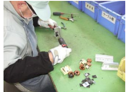
【 センタ従業員による廃OA機器の分解作業 】
